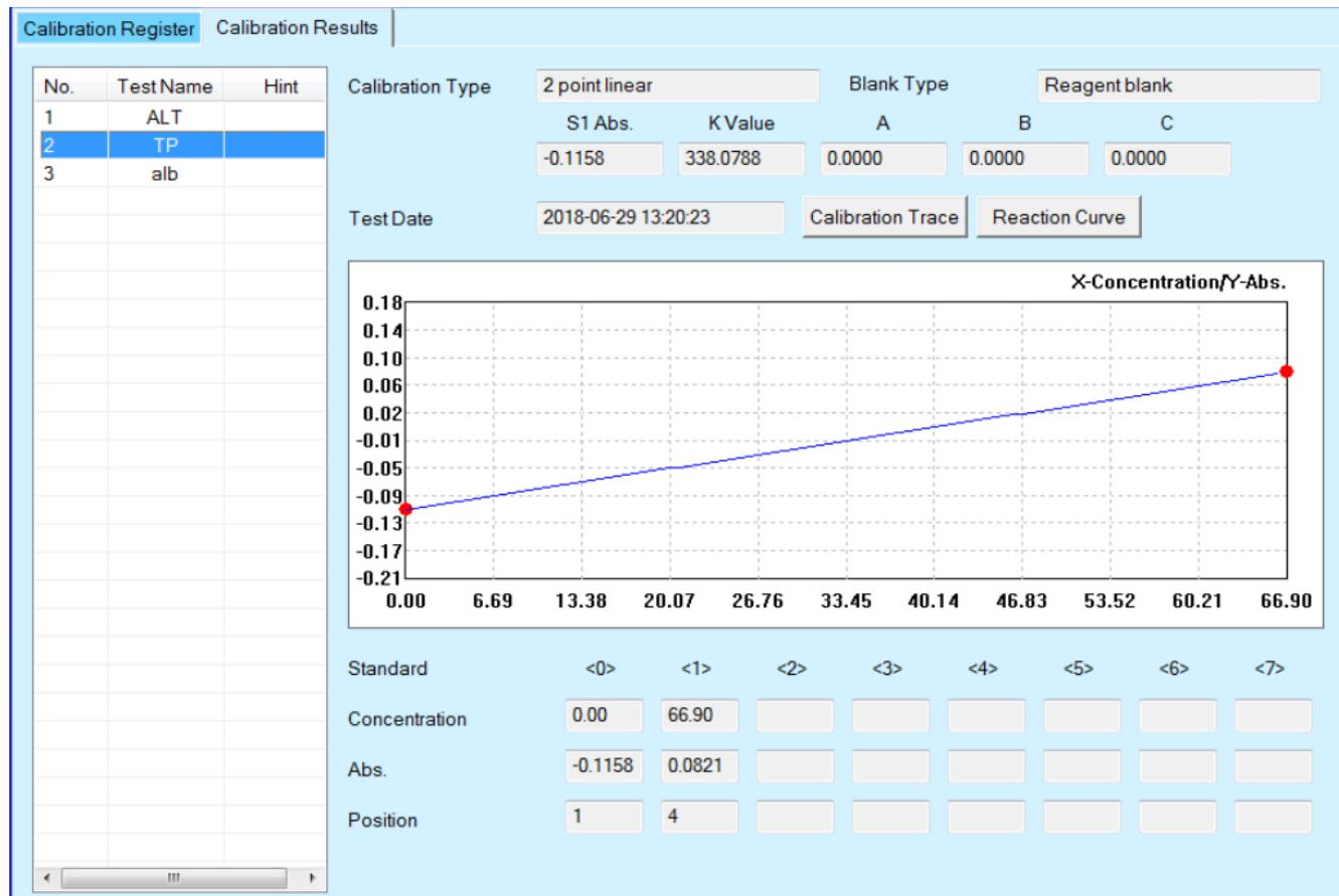
Этот экран позволяет просмотреть результаты калибровки, кривую реакции каждого стандартного раствора и калибровочную кривую.
