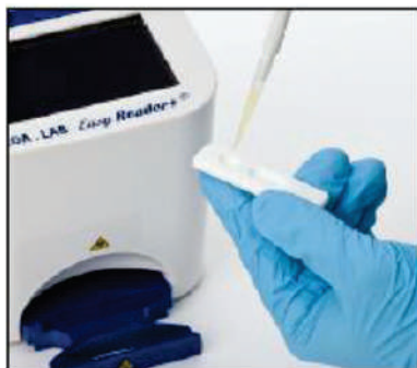
Рис. 20: Использование одноразовой пипетки для внесения указанного в инструкции объема пробы в лунку для проб на кассете.
