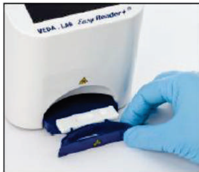
Рис. 21: Вставьте рабочую кассету в держатель и держатель внутрь анализатора.
