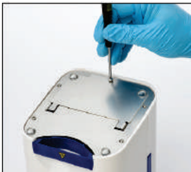
Рис. 5: Открутите крестовые винты на днище прибора, чтобы получить доступ к батарейному отсеку.
