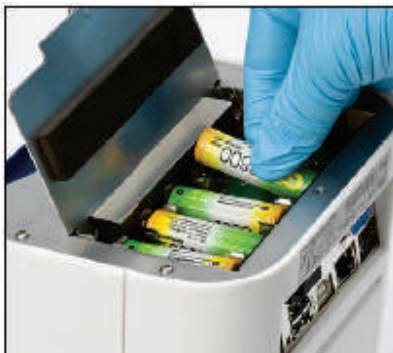
Рис. 6: При установке батарей строго соблюдайте их полярность.
