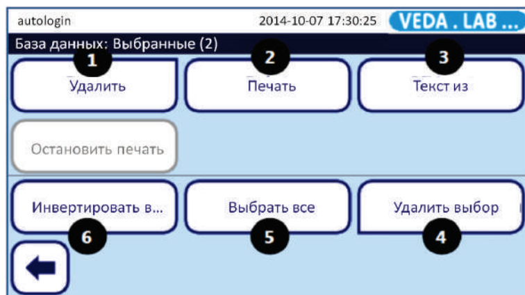
Рис. 36: Экран меню База данных КК>Выбранное (QC Database>Selected) с отмеченными функциональными кнопками: Удалить (1), Печать (2), Передача (3), Отменить Выбор (4), Выбрать все (5), Инвертировать выбор (6)
