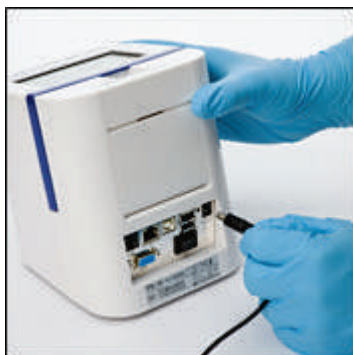
Рис. 4: Подключение кабеля сетевого адаптера к анализатору
