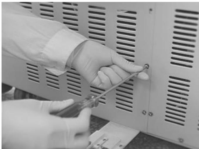
с) Снимите заглушку и слейте воду из резервуара.
