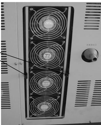
(b) Прочистите сетку пылесосом, затем промойте водой. Протрите сухой тканью.
