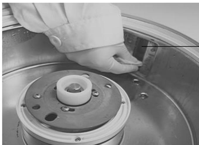
с) Снимите диск для образцов и протрите дно влажной тканью.
