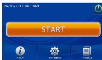
Прежде чем вставить реакгентный диск в биохимический анализатор, убедитесь в правильности установки диапазона референсных норм и единиц измерения показателей (более подробно это описано в разделах 6.2.4 и 6.2.5). Также проверьте наличие термобумаги во встроенном термопринтере, и завершена ли установка внешнего принтера и других подключенных устройств (если используются).
