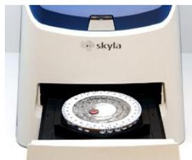
Возьмите реактентный диск с внесенной пробой за края и держите его горизонтально, поверхностью со штрих-кодом вверх. Не касаясь поверхности реактентного диска, аккуратно поместите диск в отсек и нажмите кнопку **OK** для его закрывания.
